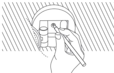
2) 使用直径6mm的钻头根据描点位置在墙壁打孔,钻孔深度≥32mm。
